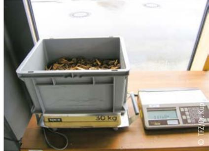
Für eine nachträgliche Bestimmung des Wassergehaltes wird das Nettogewicht der Rückstellprobe direkt im Anschluss an die Probennahme ermittelt.
