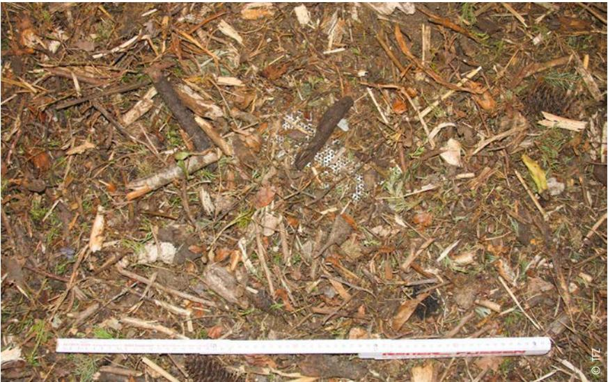
Abb. 6: Hackschnitzel mit Nadeln, Rinde, feinen Ästen und deutlichen Verunreinigungen mit Mineralboden. Aschegehalt  $> 10$  Masse-%, für den emissionsarmen Betrieb von Kleinfeuerungen nicht geeignet.
