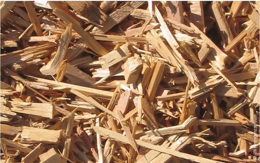
Abb. 10: Hackschnitzel, rindenfrei, aber geschreddert (keine glatten Schnittkanten), für den emissionsarmen Betrieb von Kleinfeuerungen nur bedingt geeignet.
