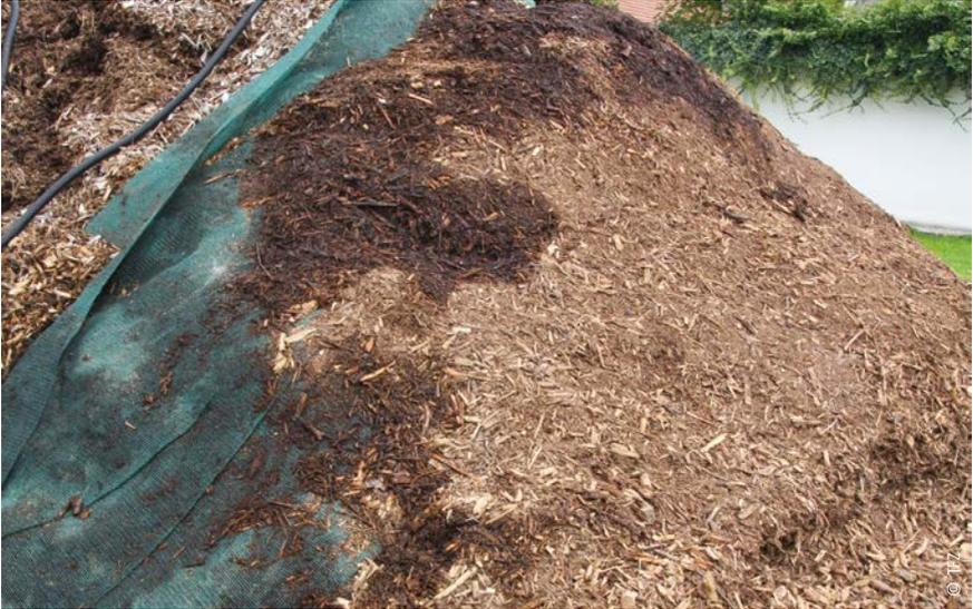
Abb. 9: Deutlich sichtbare Feuchtenester und hohe Feinanteile im Hackschnitzelhaufen, für den emissionsarmen Betrieb von Kleinfeuerungen nicht geeignet.
