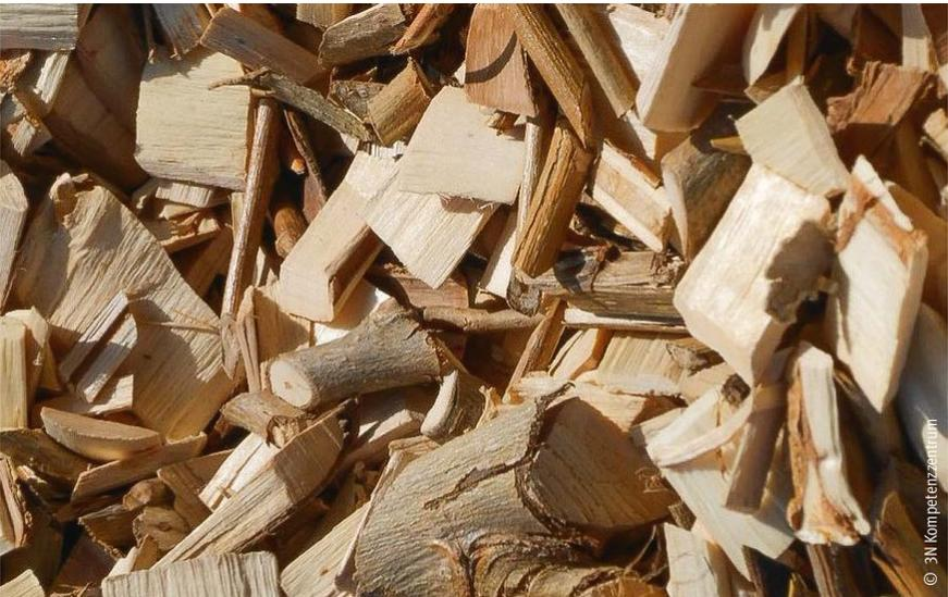
Abb. 4: Hackschnitzel aus Kurzumtrieb ohne Blätter, mit Rinde und feinen Ästen. Aschegehalt < 2 Masse-%, für den emissionsarmen Betrieb von Kleinfeuerungen nur bedingt geeignet.
