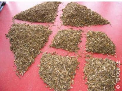
Die Rückstellprobe (ca. 10 l) wird durch mehrfache Viertelung von der Gesamprobe abgetrennt
