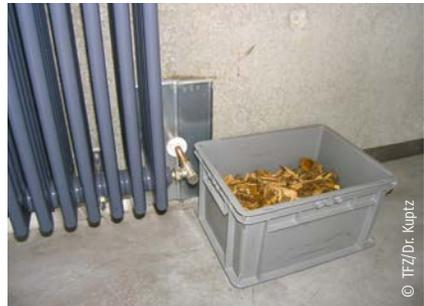
Um Schimmelbildung vorzubeugen, sollten feuchte Proben vor dem Verschließen an der Luft getrocknet werden.
