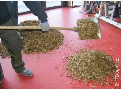
Die Gesamprobe wird dreimal mithilfe einer Schaufel komplett umgesetzt.
